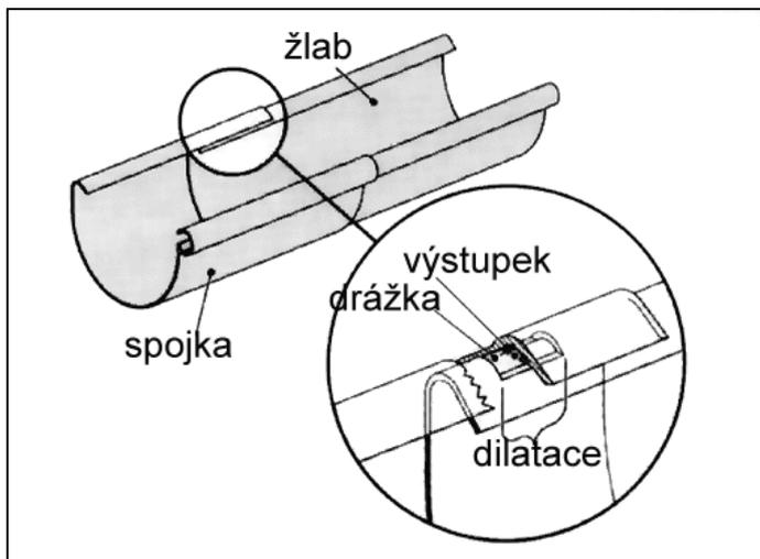
Detail spoje okapového žlabu se spojkou nebo rohem
