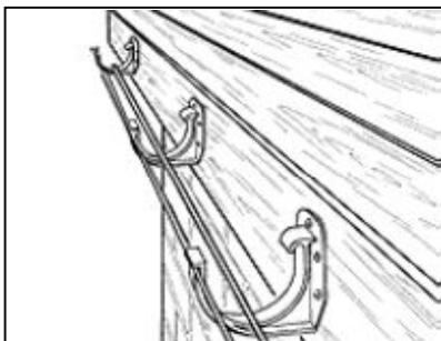
Montáž zahájíme instalací krajních háků tak, aby spád na 10 m okapového žlabu činil alespoň 2 cm. Mezi těmito háky napneme provázek a podle něj instalujeme ostatní háky. Poté do háků umístíme jednotlivé žlaby. Předem je vhodné nanést na styčné plochy mazivo na bázi mýdla, čímž je usnadněna dilatace. Dodatečně lze použít také mazivo WD-40.
