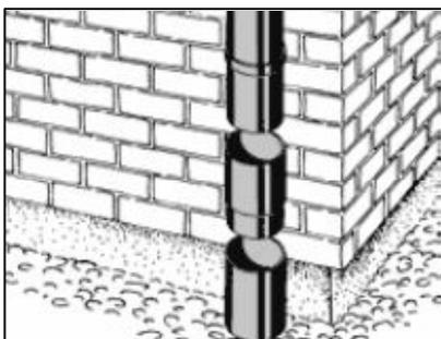
Svody jsou sesazeny „na sucho“ a ke zdi jsou upevněny pomocí trubkových spon. Těsnost není třeba řešit z důvodu dostatečně velkého spádu a spojování jednotlivých prvků ve směru toku vody. Svody lze mezi sebou spojovat jakýmkoliv jiným prvkem (koleno apod.), pro vzájemné spojení v rovném úseku je třeba přibjednat spojku svodu (hrdlo).
