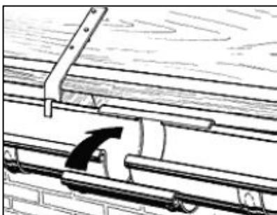
Následně jednotlivé díly spojíme pomocí spojek nebo rohů (dále jen tvarovky). Vždy dáváme pozor, aby okraj žlabu byl přesně na rysce tvarovky – tím je zajištěno, že výstupek
